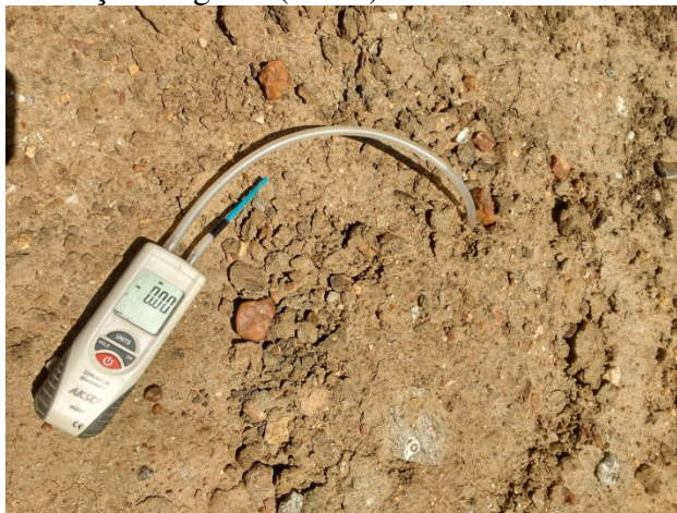
Figura 55. Monitoramento de pressão diferencial nos dispositivos de medição de concentração de gases (DMC) na interface solo-resíduo
