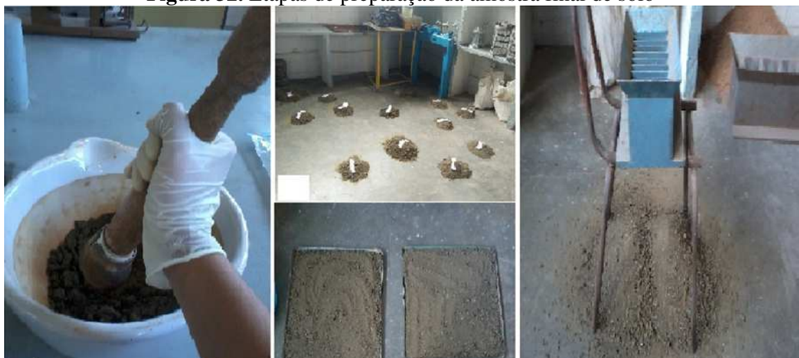
(a) destorroamento das amostras de solo (b) e (c) secagem ao ar livre e homogeneização (d) quarteamento
