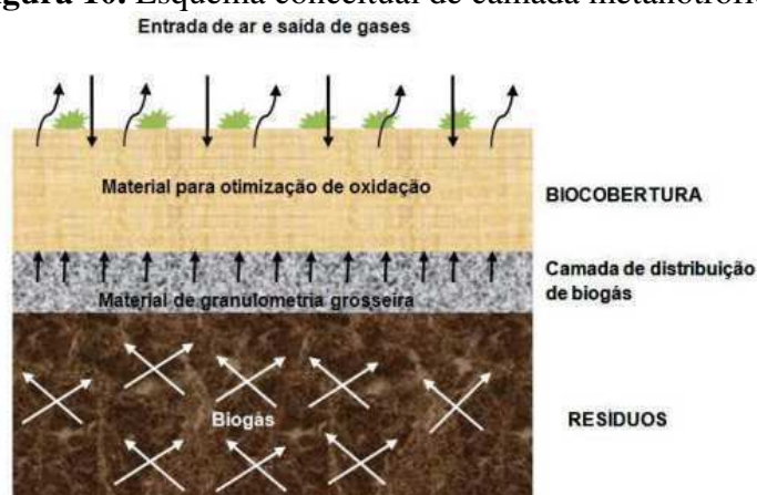
Figura 10. Esquema conceitual de camada metanotrófica
