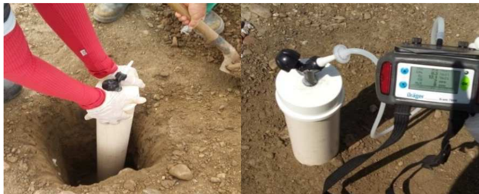
(c) colocação de camada de brita e instalação do dispositivo (d) dispositivo pronto para monitoramento
