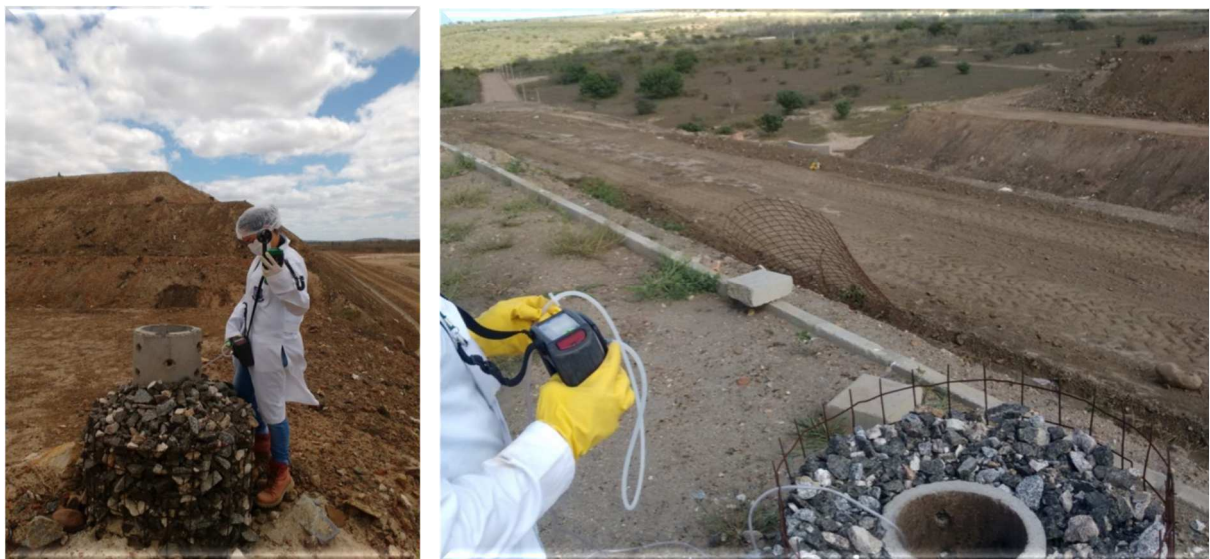
(a) monitoramento com o detector portátil de gases (b) detalhe do equipamento Dräger, modelo X-am 7000
