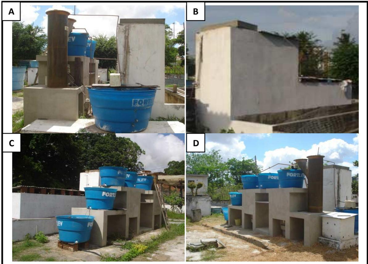
A – Vista geral dos dois sistemas experimentais; B – Lateral do experimento 1, composto por tanque séptico e filtros de areia em regime de fluxo intermitente; C e D – Experimento 2, composto por reator UASB e filtros de areia em regime de fluxo intermitente.
