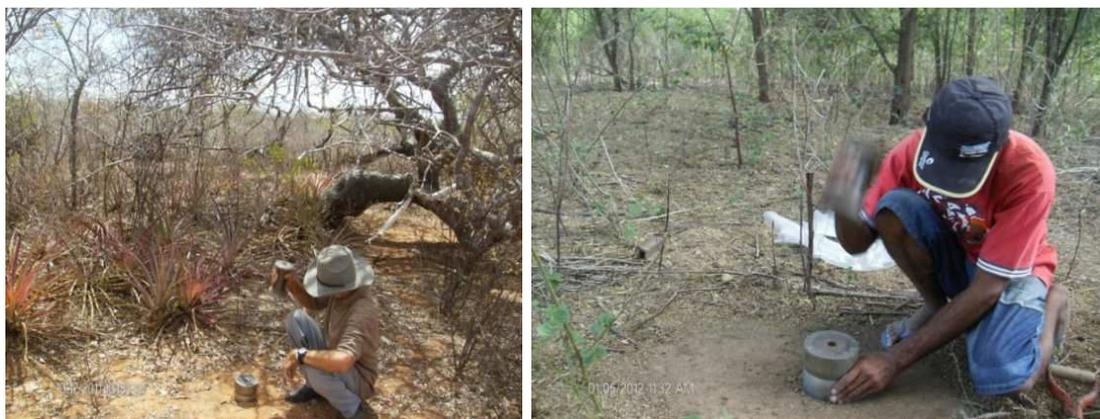
**Figura 17** – Operação para extração da amostra indeformada e determinação da densidade de campo.
