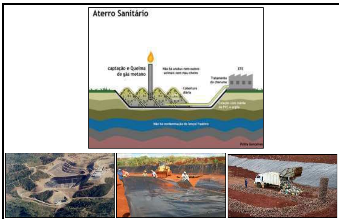
Figura 10: Representação de um aterro sanitário.
