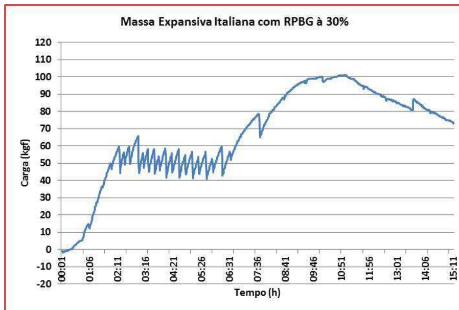
Figura 83: Teste de longa duração com argamassa italiana (Fracta.Ag), adicionada de 30% do resíduo do processo de beneficiamento do granito (RPBG)
