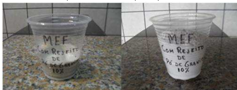
Figura 19: A esquerda recipiente com argamassa expansiva italiana Fracta.Ag adicionada de resíduo de granito preparada antes da expansão e a direita após expansão
