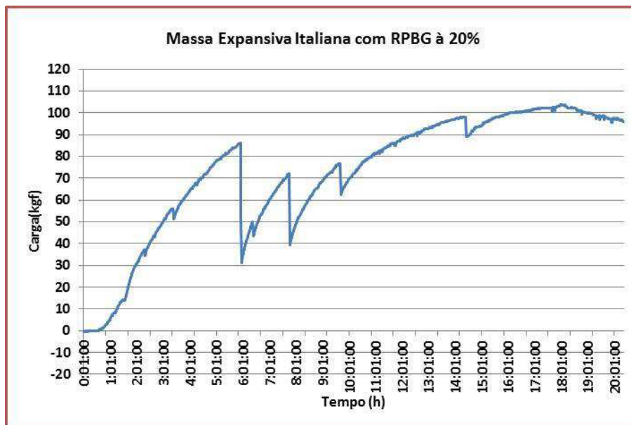
Figura 82: Teste de longa duração com argamassa italiana (Fracta.Ag), adicionada de 20% do resíduo do processo de beneficiamento do granito (RPBG)
