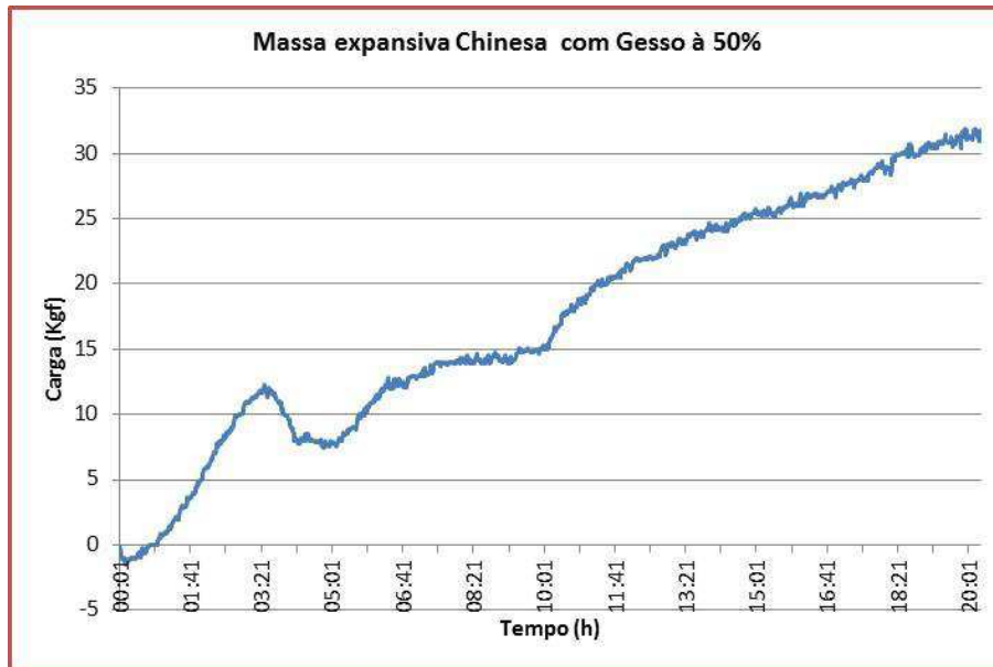
Figura 57: Teste de longa duração com argamassa chinesa (Chemshine), adicionada de 50% de gesso
