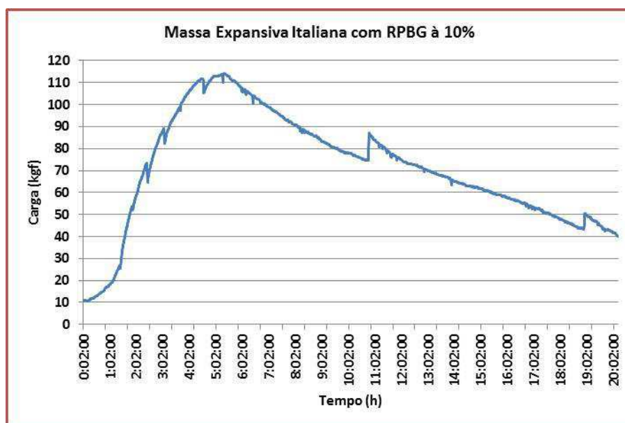
Figura 81: Teste de longa duração com argamassa italiana (Fracta.Ag), adicionada de 10% do resíduo do processo de beneficiamento do granito (RPBG)
