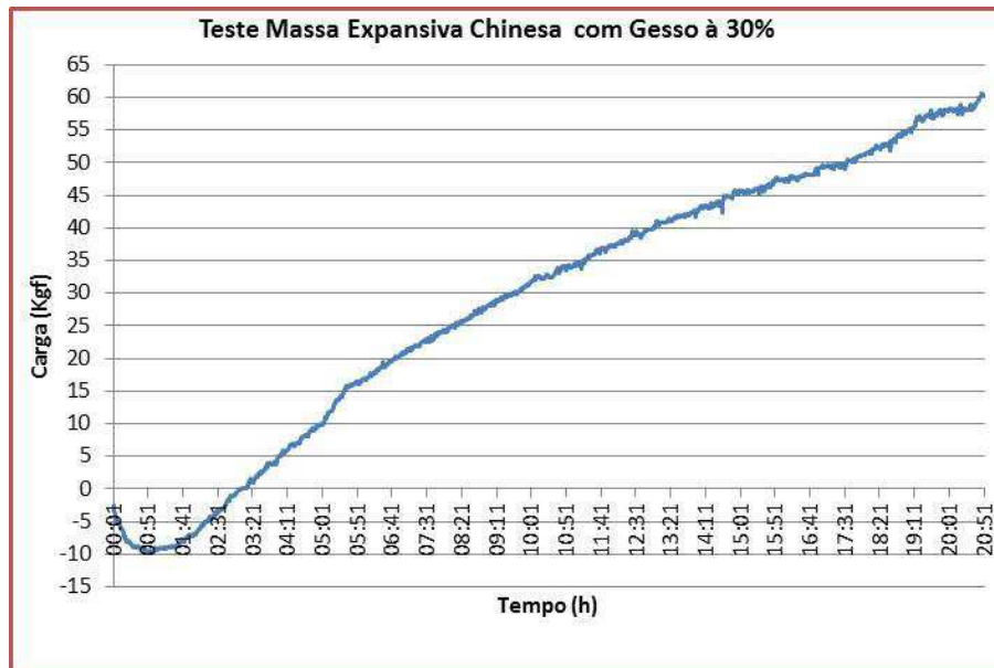
Figura 55: Teste de longa duração com argamassa chinesa (Chemshine), adicionada de 30% de gesso
