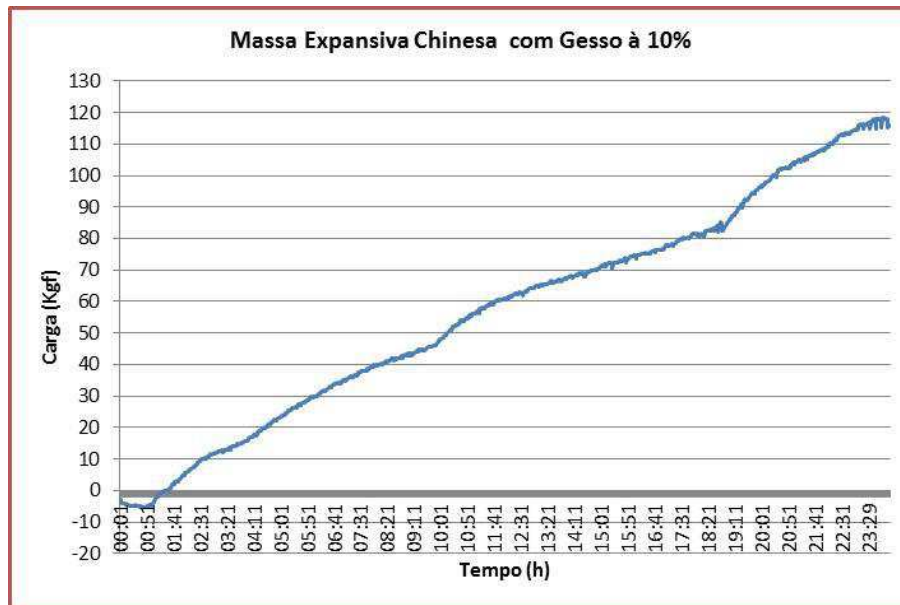
Figura 53: Teste de longa duração com argamassa chinesa (Chemshine), adicionada de 10% de gesso
