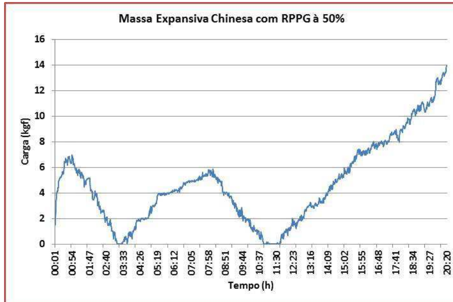
Figura 69: Teste de longa duração com argamassa chinesa (Chemshine), adicionada de 50% do resíduo do processo de perfuração do granito (RPPG)
