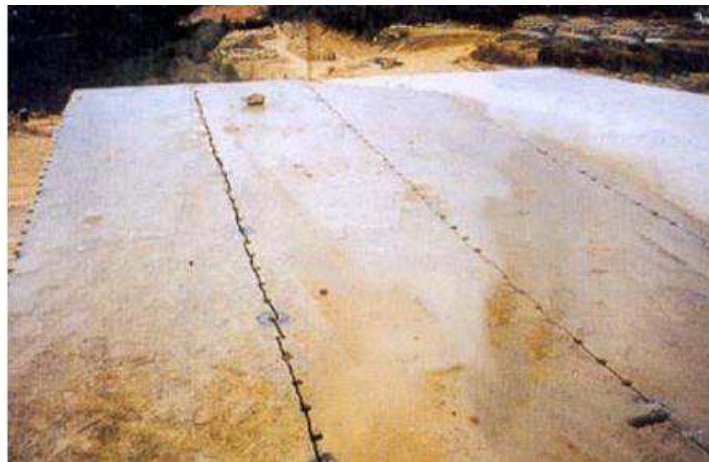
Figura 5: Corte em granito através de argamassa expansiva. Granito "Amarelo Veneziano". Notar sua pequena espessura com perda mínima de material
