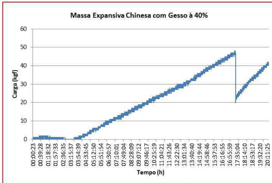
Figura 56: Teste de longa duração com argamassa chinesa (Chemshine), adicionada de 40% de gesso
