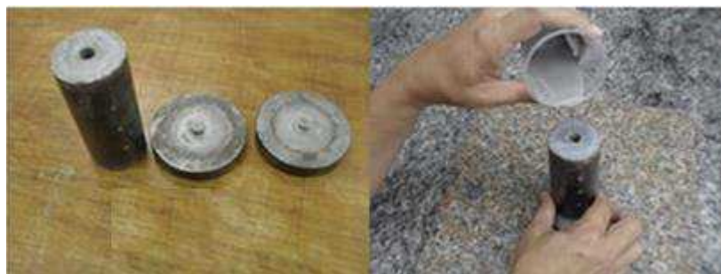
Figura 17: Molde e colocação da mistura
