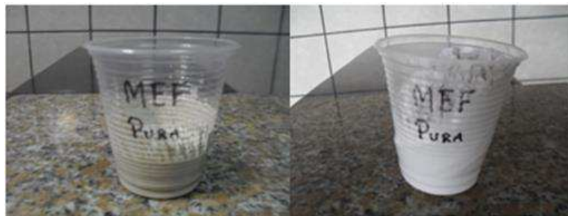
Figura 18: A esquerda recipiente com argamassa expansiva italiana “Fracta.Ag” pura preparada antes da expansão e a direita após expansão
