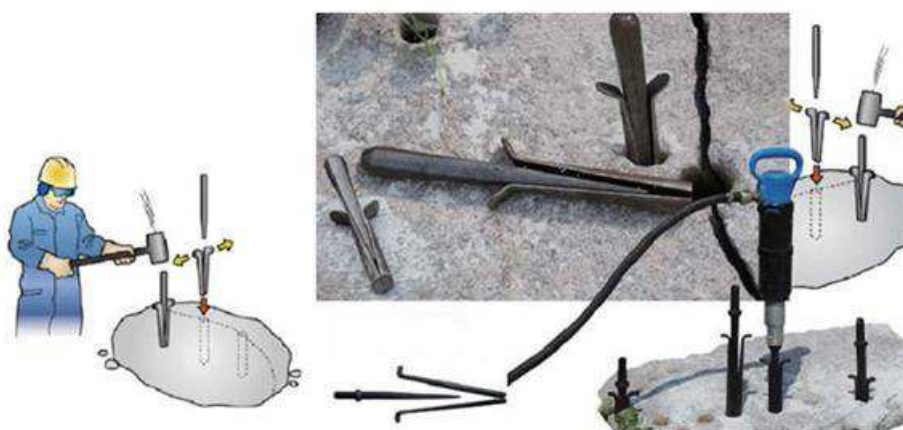
Figura 4: Abertura através de cunhas
