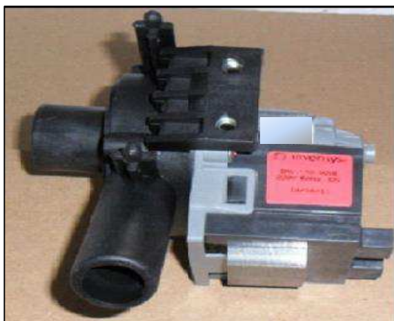
Figura 3.4 Eletrobomba usada para manter a DQO suspensa no reservatório afluente ao RBS.
