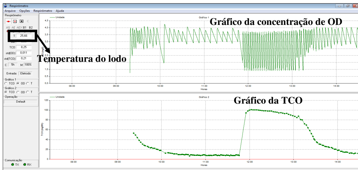
Figura 3.10 Respirograma gerado pelo software RespS4022c em conjunto com o respirômetro Beluga.
