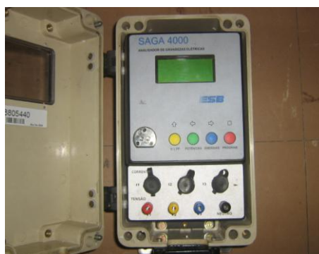
Figura 15 – Registrador de variáveis elétricas Saga 4000
