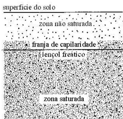
Figura 4 - Água no subsolo
