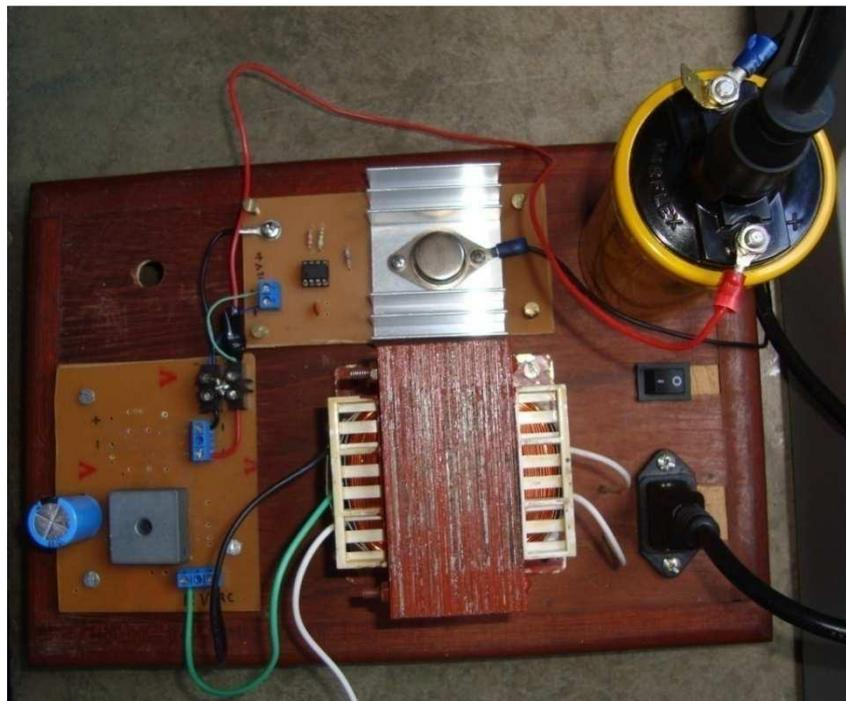
Figura 3.4 – Foto do protótipo do circuito de ignição.
