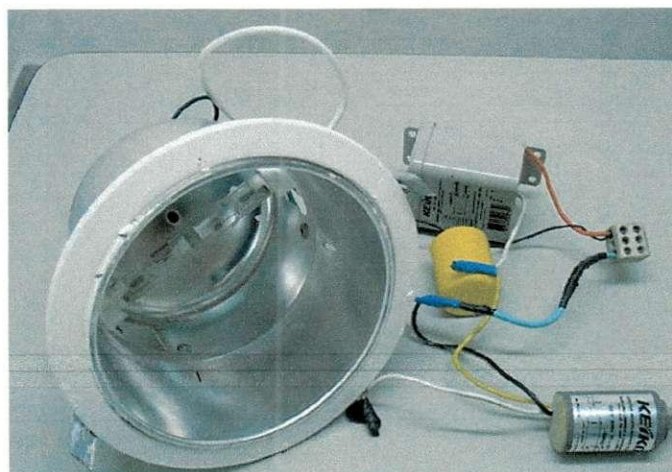
Figura 06 – Conjunto (luminária + lâmpada HQL + ignitor + reator + capacitor) pronto para instalação.
