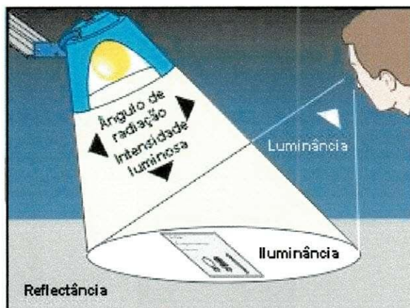
Figura 02 – Definição ilustrada de Iluminância ou Iluminamento.
