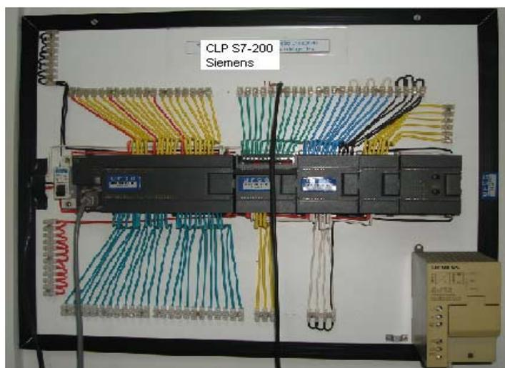
Figure 18 - O CLP S7-200 com módulos instalados na plataforma
