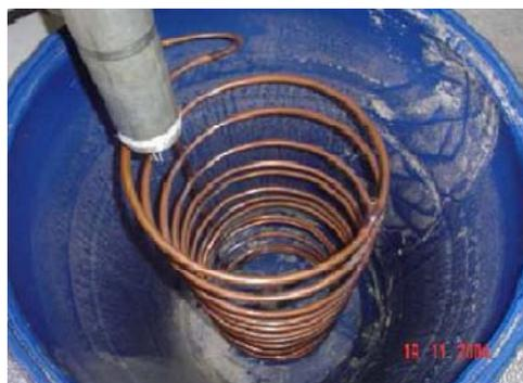
**Figura 8 - Malha de refrigeração dentro do reservatório**
