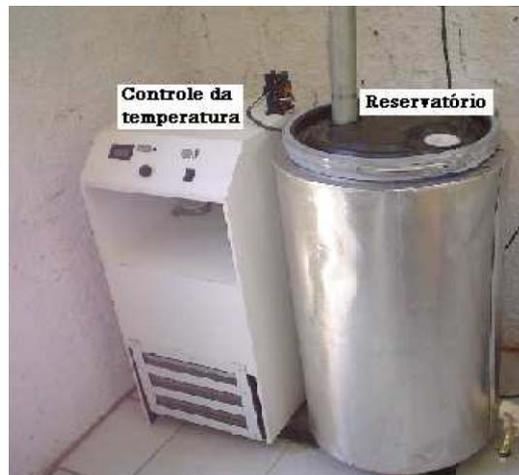
**Figura 7 - Reservatório e módulo de controle**
