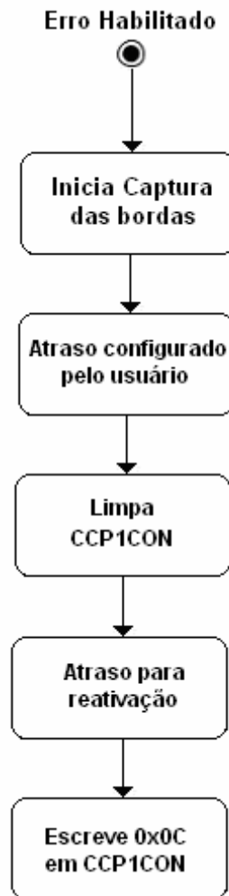
Figura 3.5: Fluxograma para implementação da falha no PWM
