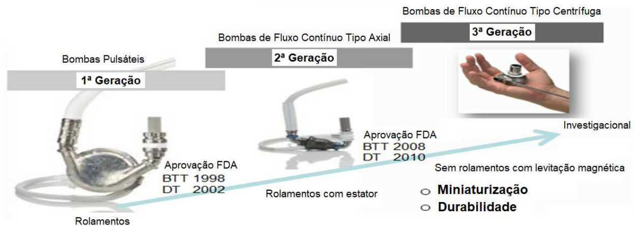
Figura 2.14: Linha do tempo representando as três gerações de DAVs (Adaptado de: Yamane [55]). Legenda: DT = Destination therapy ; BTT = Bridge to transplant ; FDA = Food and Drug Administration .
