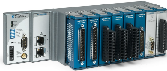
Figura 6.8: Imagem do NI cRIO-9073 com os módulos E/S da Série C (Fonte: National Instruments Corporation [134]).
