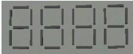
Figura 17 – Mostradores de 7 segmentos dispostos lado a lado
