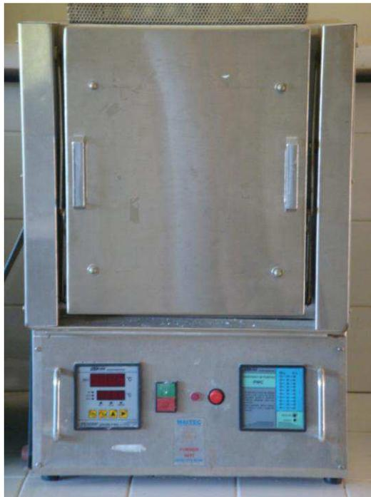
**Figura 4.2 - Forno convencional utilizado na queima dos corpos de prova**
