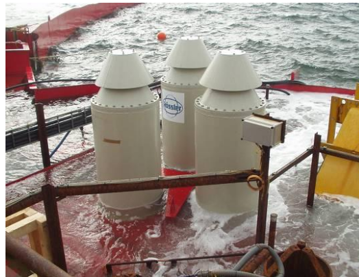
Figura 3.15: Conjunto de turbinas Kaplan de um protótipo do Wave Dragon
