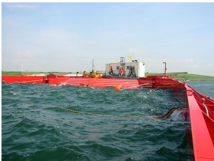
Figura 3.12: Dispositivo de galgamento Wave Dragon localizado na Dinamarca Fonte: Wave Dragon, 2009.
