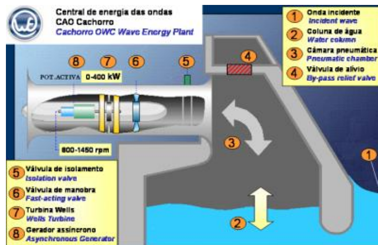
Fig. 3.5: Esquema de uma central de coluna de água oscilante (Wavegen)
