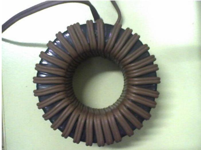
**Figura 4** – Transformador em forma de toroide composto por uma liga Fe-Si de grãos orientados no núcleo e fios geminados formando os enrolamentos ( $n = 1:1$ ).
