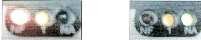
Figura 24 - LEDs dos Contatos - Na Esquerda NF Ativo, Na Direita NA Ativo
