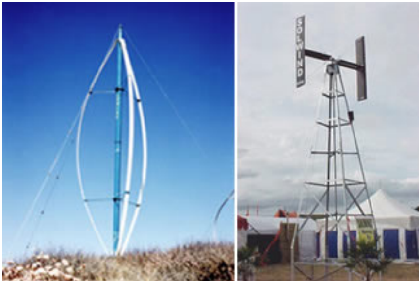
Figura 2 - Turbinas Eólicas de Eixo Vertical
