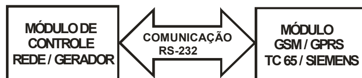
Figura 28 – comunicação entre módulo K30 e modem GPRS.
