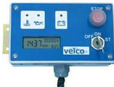
Figura 17 – Painel de instrumentos do grupo gerador [21] .
