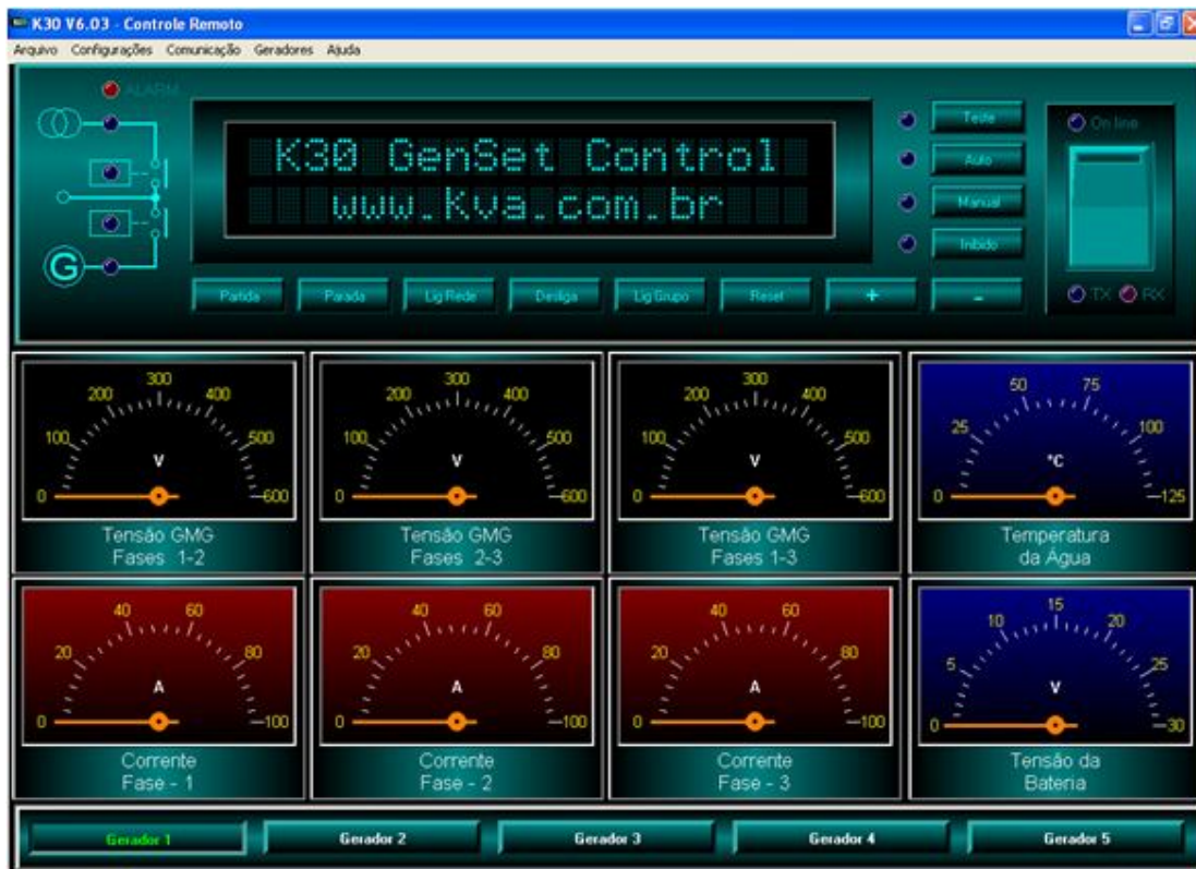
Figura 20 – Interface do software de gerenciamento remoto da KVA [10] .
