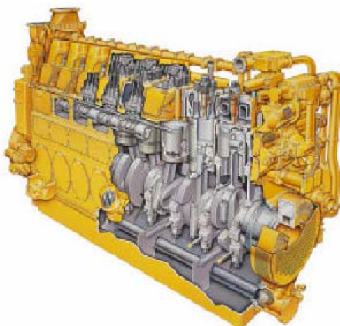
Figura 4.2 - Motor de combustão interna Caterpillar, (Rubenildo Vieira Andrade, 2007).
