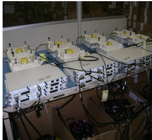
Figuras 15: Montagem dos rádios MXC Alcatel-Lucent para a configuração
