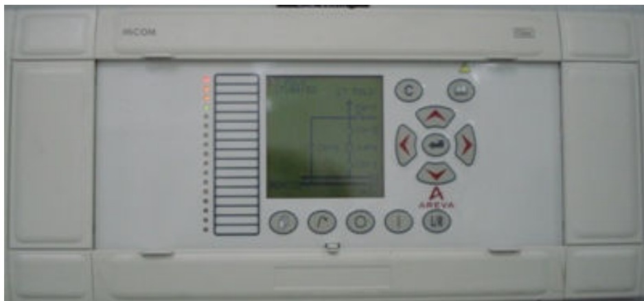
Figura 5.2 – Unidade de Controle – Micom C264
