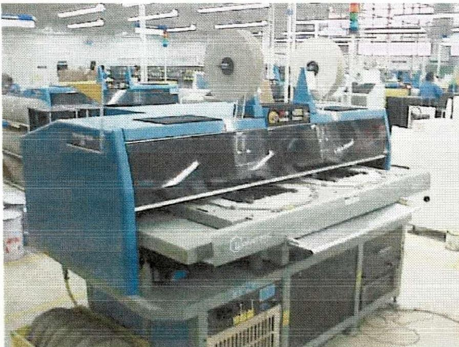
FIG. 7: INSERÇORA DE COMPONENTES AXIAIS
