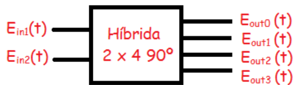
Figura 3: Bloco funcional de uma híbrida 2 \times 4 \text{ } 90^\circ .
