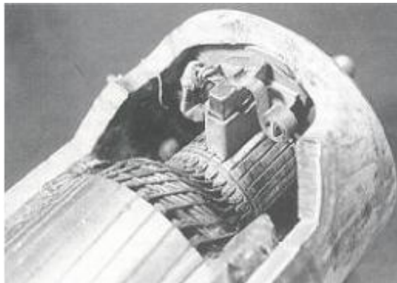
Figura 2 - Motor CC. Detalhe das escovas de carvão, comutador, enrolamento de armadura e ranhuras do rotor. Ilustração retirada o livro Máquinas Elétricas, 6ªEd, Fitzgerald, A. E.; Kinsley, Charles Jr; Umans, Stephen D. Editora Bookman, 2006 [3].
