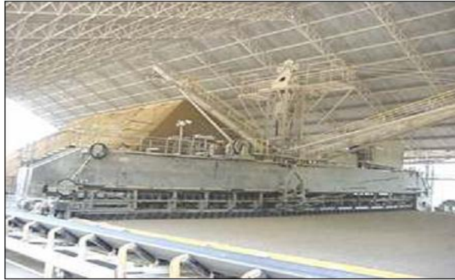
Figura 3.3 - Retomador de Calcário
