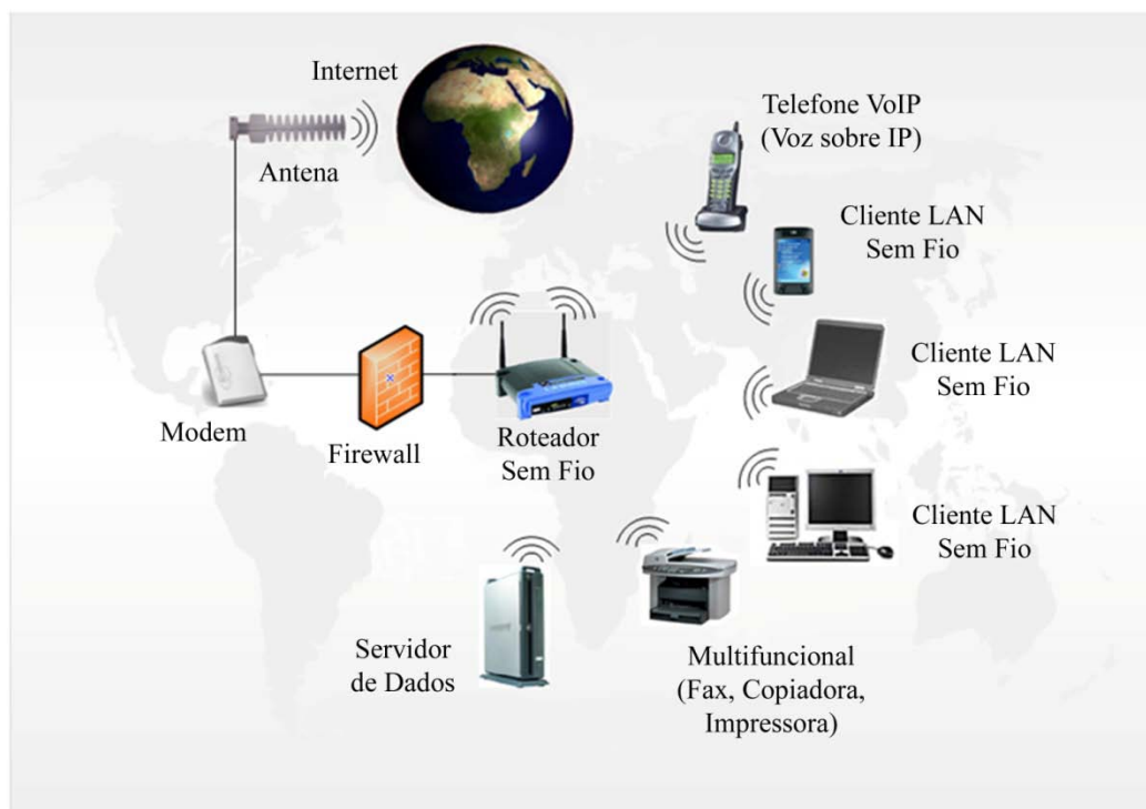
Figura 11 – Configuração típica de uma rede de acesso sem fio local.
