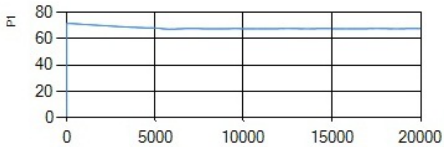
Figura 18: Pressão na ponto baixo do encanamento (P1)
