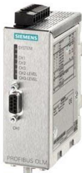
Figura 3.6 – Foto de um conversor RS-485/fibra ótica para rede Profibus [18].
