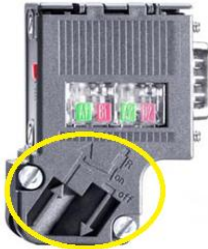
Figura 3.3 – Representação do conector com terminador [21].
