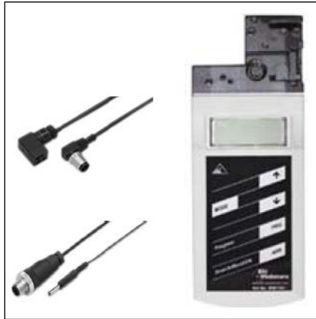
Figura 6.15 – Foto do dispositivo de programação de endereços AS-i e seus cabos [24].
