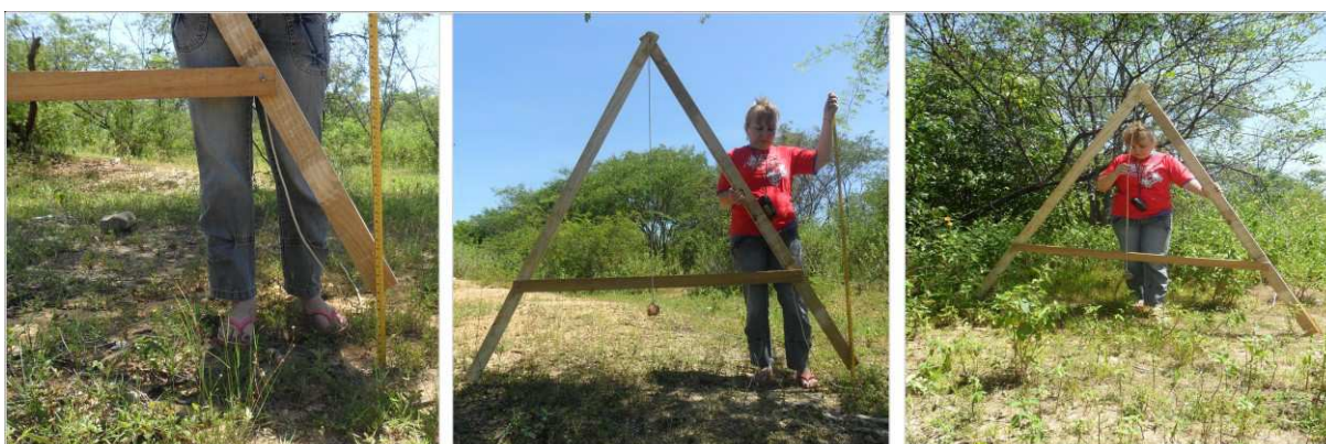
Figura 5: Determinação da declividade com esquadro triangular de fio de prumo. Fonte: Aristeia C. de Melo (2011).
