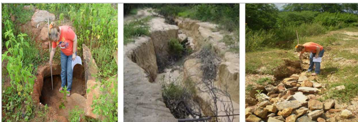
Figura 6: Determinação da profundidade e extensão das ravinas e voçorocas. Fonte: Aristeia C. de Melo e produção da autora (2011).
