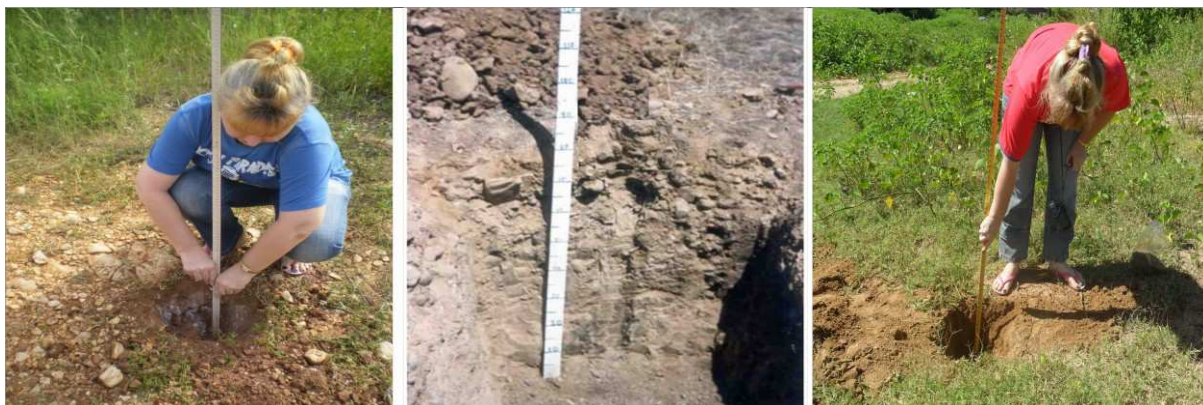
Figura 2: Determinação da profundidade efetiva dos solos. Fonte: Aristeia C. de Melo e produção da autora (2011).
