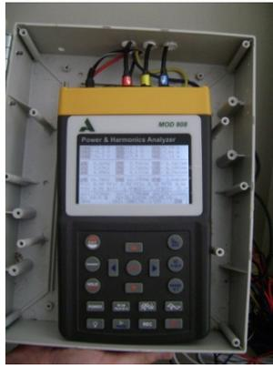
Figura 5.2: Analisador de Energia utilizado.
