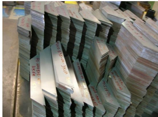
**Figura – Fotografia de lâminas de aço-silício.**
