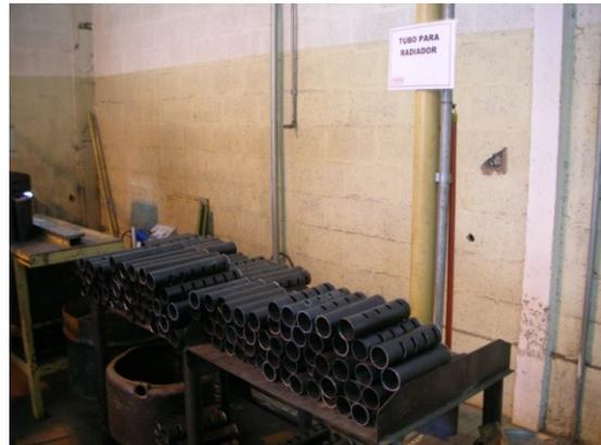
**Figura – Fotografia dos tubos nas quais as chapas do radiador serão soldadas.**
