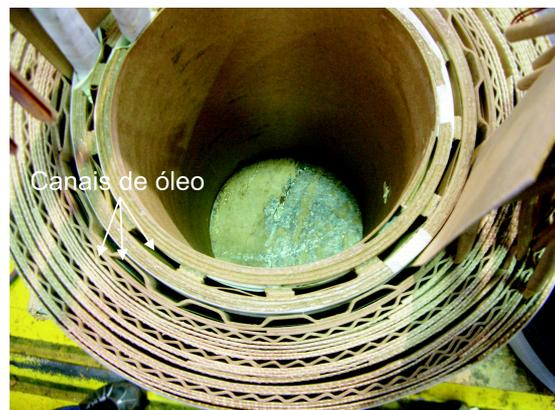
**Figura – Fotografia mostrando o condutor retangular, neste caso sendo usado na BT, e o isolamento do mesmo.**
