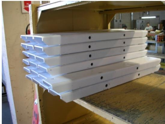
Figura – Fotografia das barras de ferro que prendem o núcleo.
