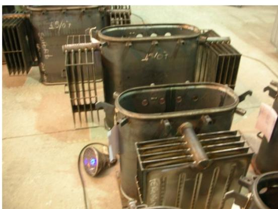
**Figura – Fotografia do tanque pronto esperando a pintura.**
