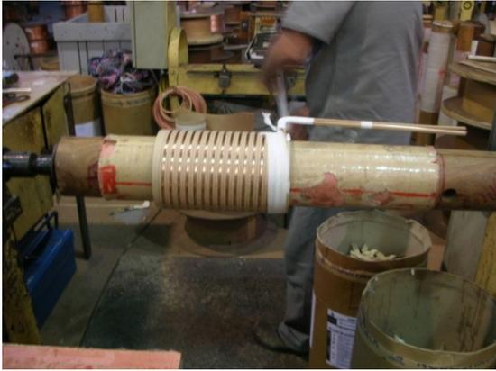
**Figura – Fotografia do enrolamento BT sendo confeccionado.**
