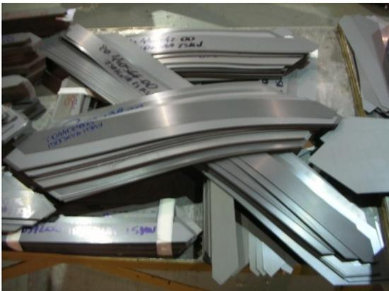
**Figura – Fotografia de lâminas de aço-silício cortadas que compõem a perna central.**
