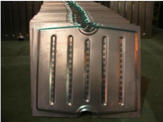
**Figura – Fotografia das chapas do radiador cortadas, modeladas e soldadas aos pares.**
