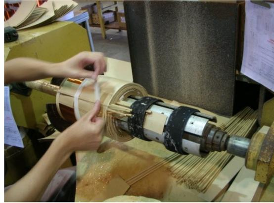
**Figura – Fotografia do enrolamento AT sendo confeccionado.**
