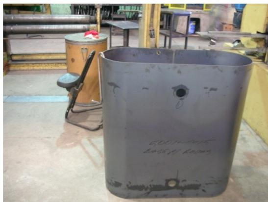
**Figura – Fotografia da chapa com as curvaturas e soldada.**
