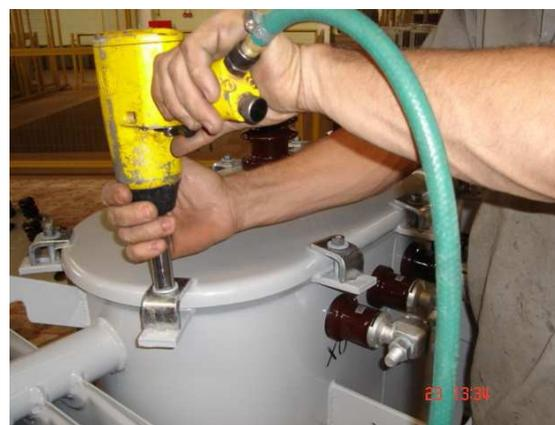
**Figura – Fotografia mostrando a tampa sendo parafusada.**
