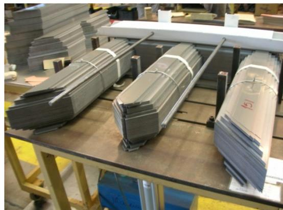
**Figura – Fotografia de núcleo monofásico sendo montado.**
