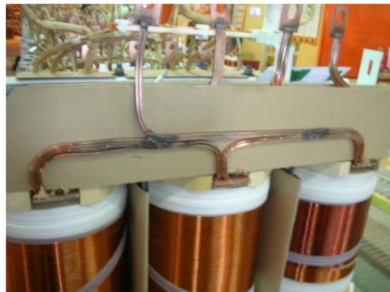
**Figura – Fotografia mostrando as soldas das ligações dos enrolamentos BT (estrela) e dos condutores nos terminais.**
