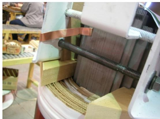
**Figura – Fotografia mostrando o aterramento do núcleo na barra de ferro, onde a mesma serve para pressionar e prender as lâminas do núcleo.**
