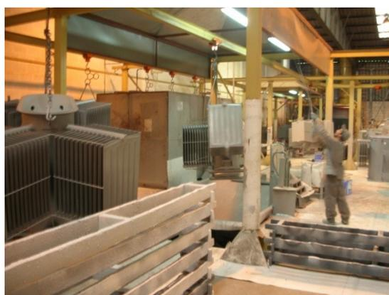
**Figura – Fotografia dos tanques passando pelo processo de pintura.**
