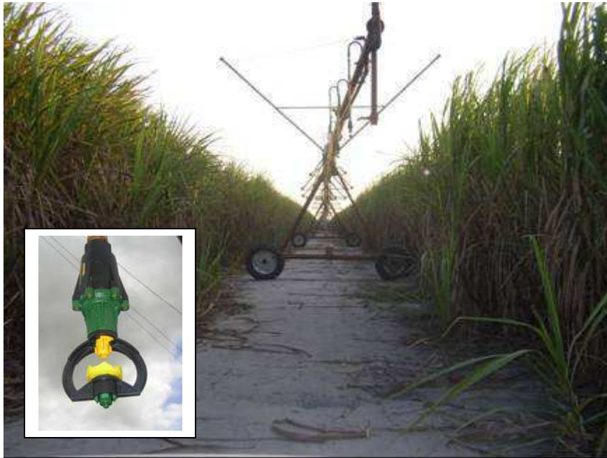
Figura 5. Imagem da área do experimento irrigado via pivô central fixo, com destaque para o emissor tipo “rotator”
