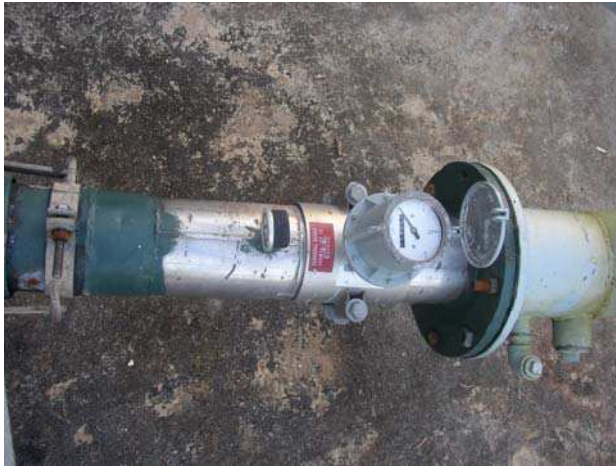
Figura 39. Medidor de vazão instantâneo (l/s) e totalizador (m 3 ) acoplado ao pivô central na Fazenda Capim II, Capim/PB, 2005
