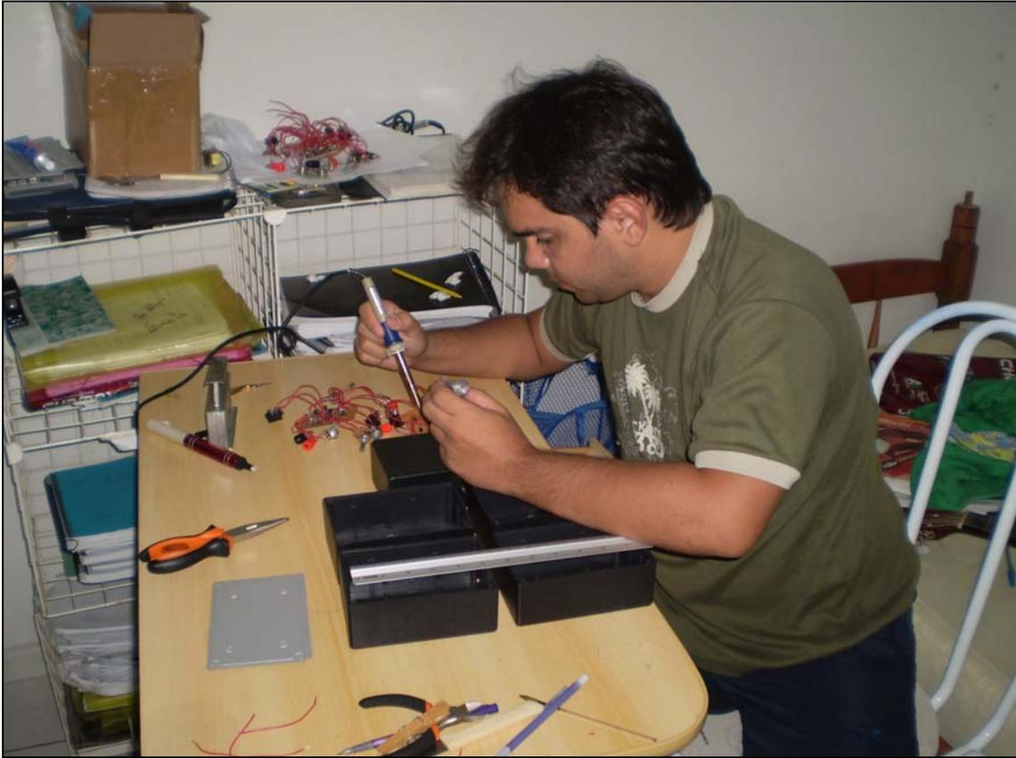
Figura 6 – Soldagem dos componentes na placa.
