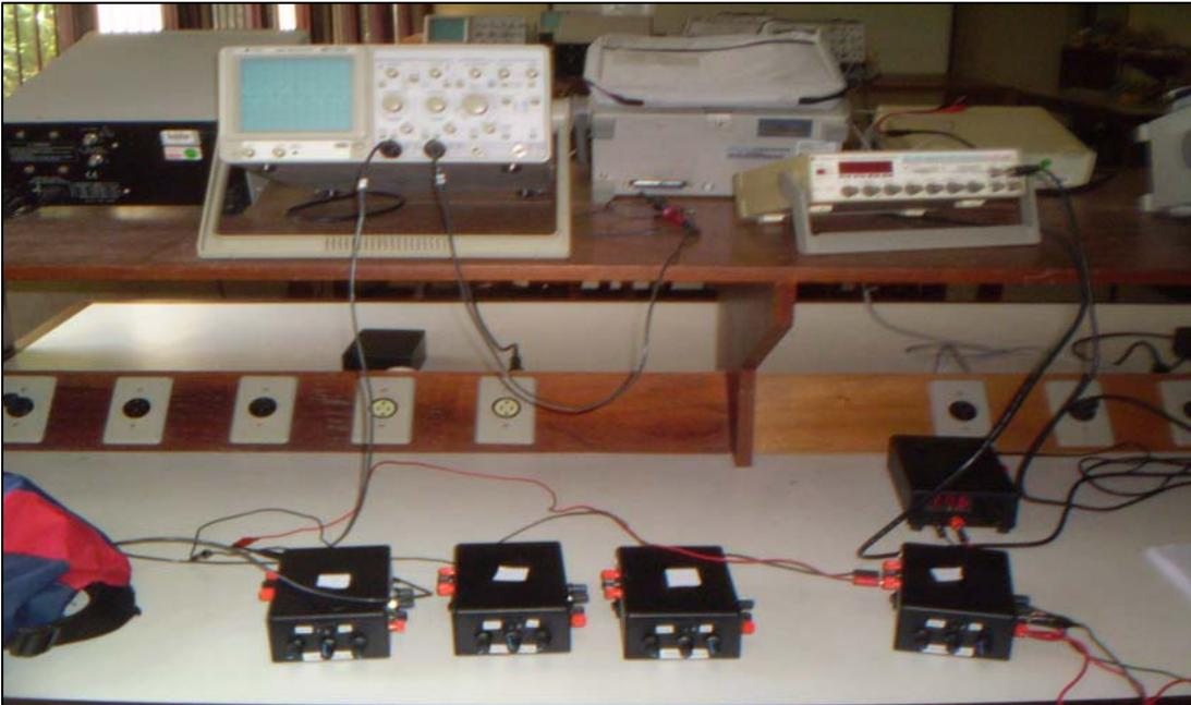
Figura 8 – Teste de funcionalidades do gerador de funções no LEC.
