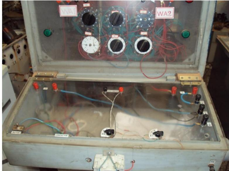
Figura 3.11 - Controles externos implementados na bancada de controle.
