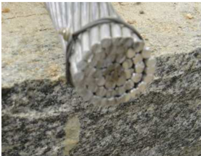
Figura 5 – Fotografia do cabo CAA 654 MCM.
