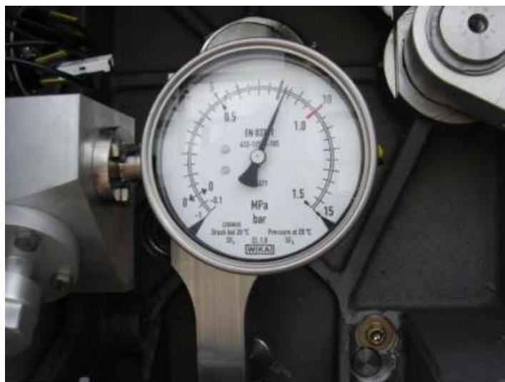
Figura 28 - Fotografia do indicador de pressão marcando a pressão final do gás no interior do disjuntor.
