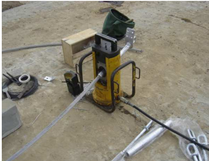
Figura 7 – Fotografia da matriz compressora hexagonal.
