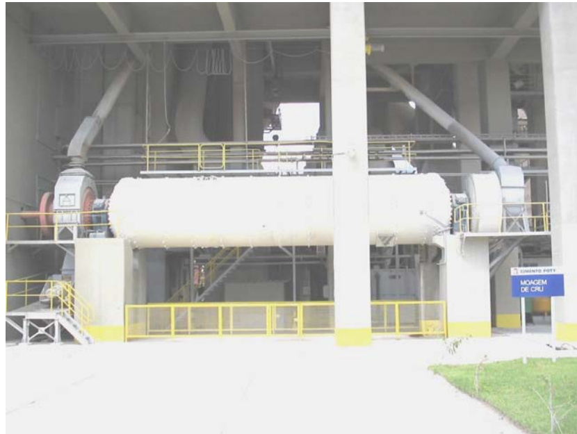
Figura 5. Fotografia do moinho de bolas de refino.
