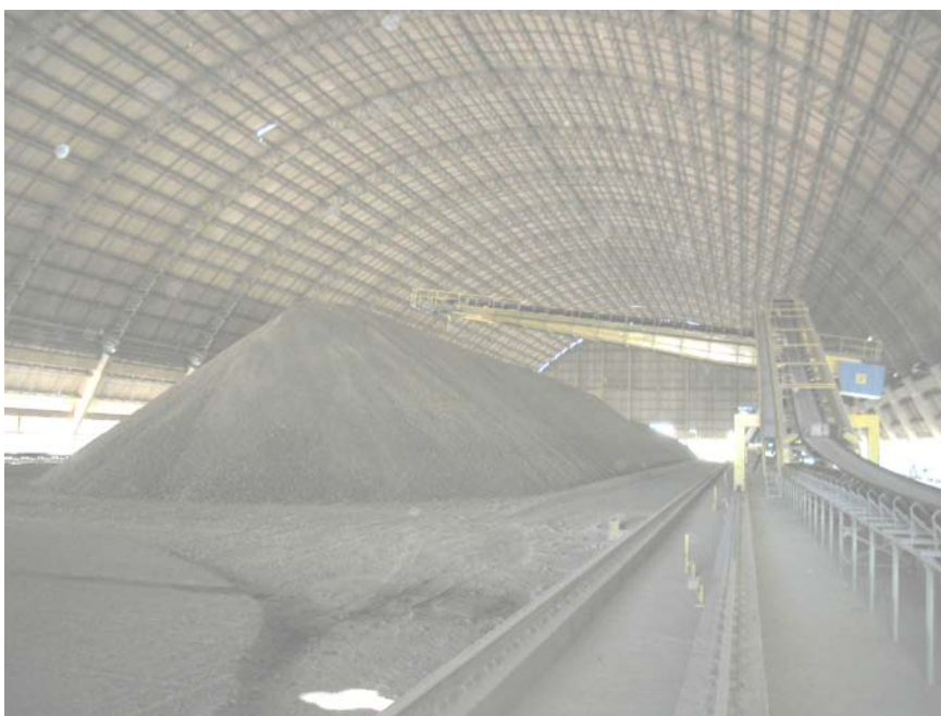
Figura 3. Fotografia do calcário sendo empilhado pelo método Chevron .
