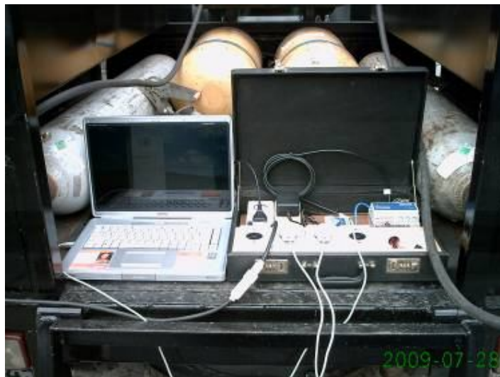
Figura 2 – Sistema de testes de estanqueidade (computador portátil e maleta).
