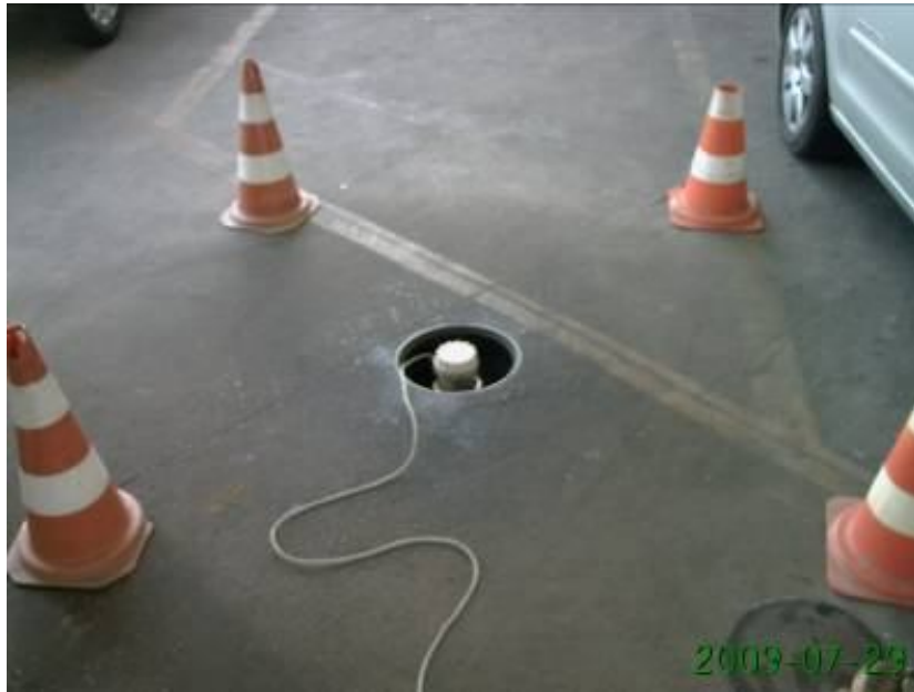
Figura 20 – monitoramento com o transmissor de nível.
