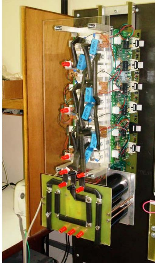
**Figura 3.21: Inversor Trifásico de Três Níveis com Diodos Grampeadores**
