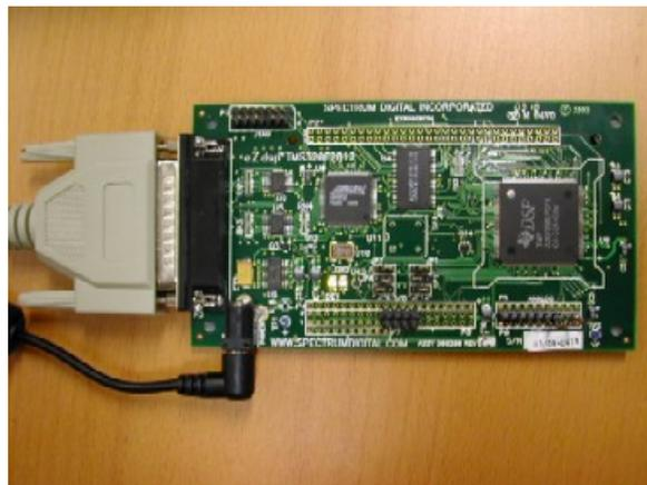
Figura 3.13: Placa de desenvolvimento eZdsp™ F2812.
