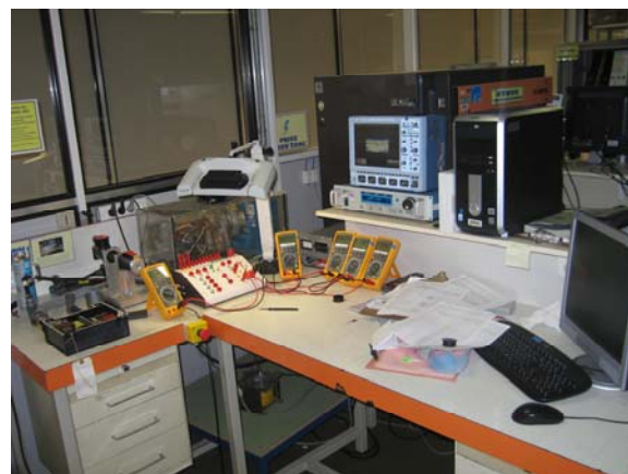
Figura 20 - (a) A bancada manual de testes para o MCU 7074 e (b) para o MCU 7062
