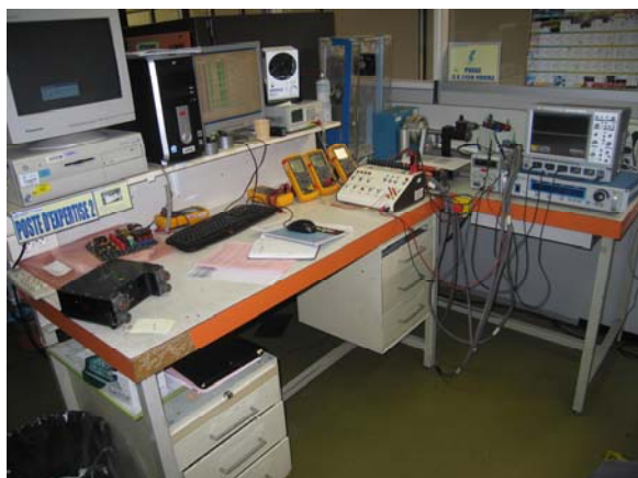
Figura 20 - (a) A bancada manual de testes para o MCU 7074 e (b) para o MCU 7062
