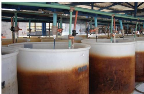
**Figura 8. Tanques para preparação de solução de  $H_2SO_4$**
