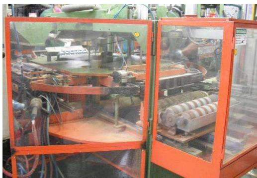
**Figura 19. Mesa rotatória utilizada na construção dos elementos.**
