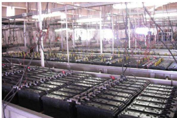
**Figura 22. Tanques utilizados no processo de formação das baterias.**
