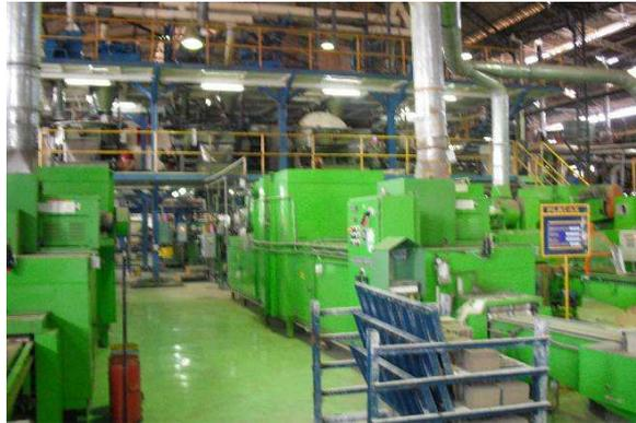
**Figura 17. Linha de empastamento, secagem e lixação.**
