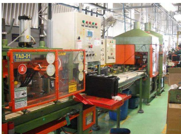
**Figura 23. Linha de acabamento das baterias.**
