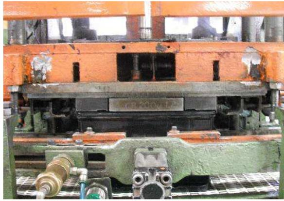
**Figura 21. Molde de aquecimento utilizado na selagem caixa/tampa.**
