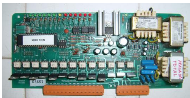
Figura 24 – Placa de potência do controlador da SERTTEL
