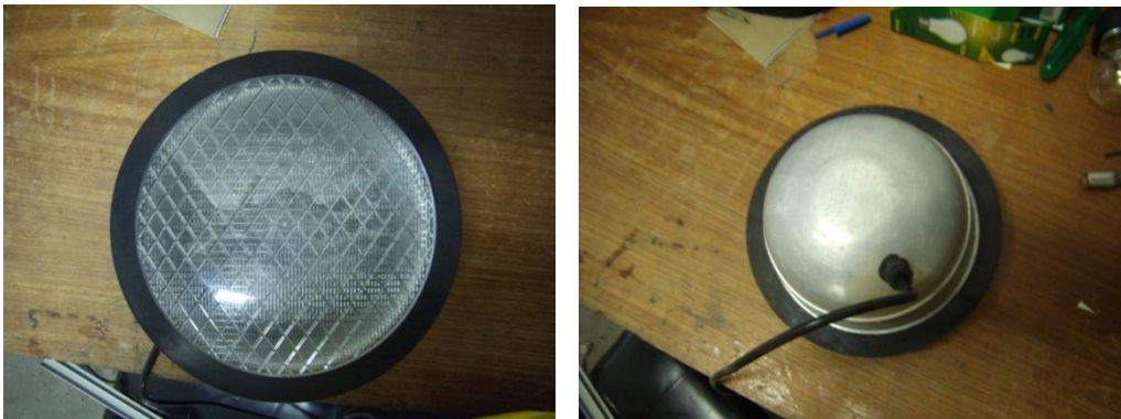
Figura 6 – Unidade focal para lâmpada com vidro transparente
