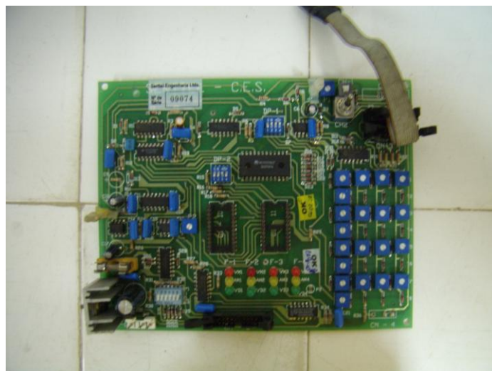
Figura 23 – Placa de controle do Controlador da SERTTEL
