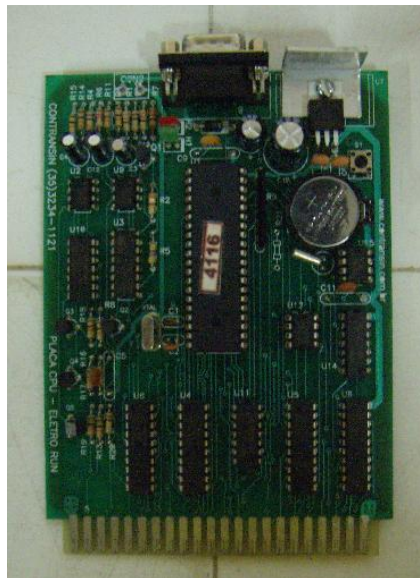
Figura 29 – Placa de Controle do Controlador da CONTRANSIN
