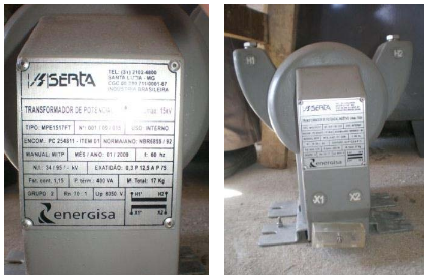
Figura 5.6 – TP de medição de relação de transformação de 70:1.
