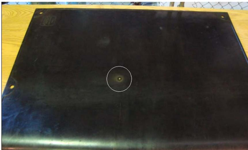
**Figura 19 – Fotografia do lençol inteiriço reprovado no ensaio devido à ocorrência de perfuração.**
