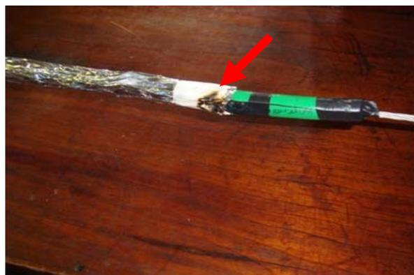
**Figura 31 – Ilustração da ocorrência de descarga, na tensão de 11,0 kV, na Mangueira para condutores durante o ensaio de descarga ou de perfuração.**
