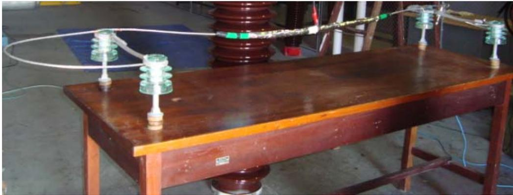
**Figura 30 – Fotografia do esquema de montagem dos ensaios de tensão suportável e tensão de descarga ou de perfuração.**
