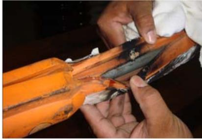
**Figura 23 – Fotografia da cobertura flexível reprovada devido a uma disrupção elétrica durante o ensaio.**
