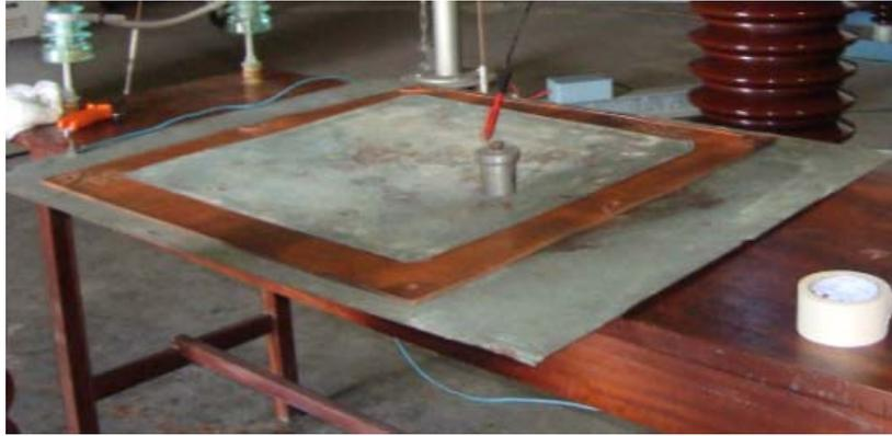
**Figura 17 – Fotografia do esquema de montagem para a realização do ensaio em lençóis inteiriços.**
