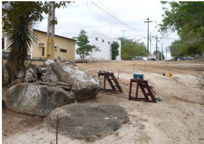
Figure 41 – Fotografia do esquema de montagem do ensaio com hastes dispostas em linha.
