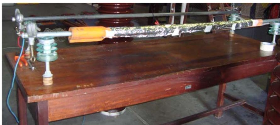
**Figura 22 – Fotografia do esquema de montagens para a realização do ensaio para as coberturas para condutores do tipo flexível.**
