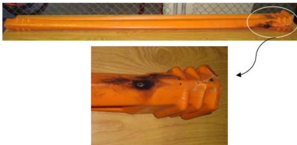
**Figura 21 – Fotografia da cobertura protetora para condutores do tipo rígida reprovado no ensaio devido à ocorrência de perfuração.**
