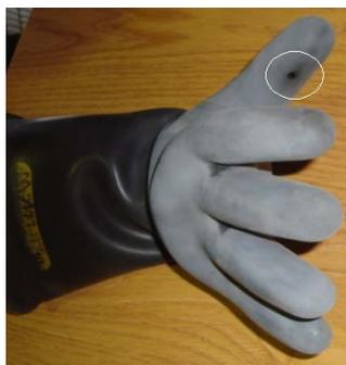
**Figura 14 – Fotografia da luva isolante que sofreu uma perfuração durante o ensaio.**
