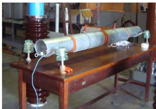
**Figura 24 – Fotografia do arranjo do ensaio de cobertura circular rígida.**
