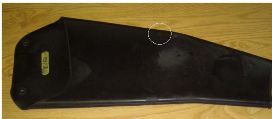
**Figura 16 – Fotografia da manga reprovada no ensaio devido à ocorrência de perfuração.**
