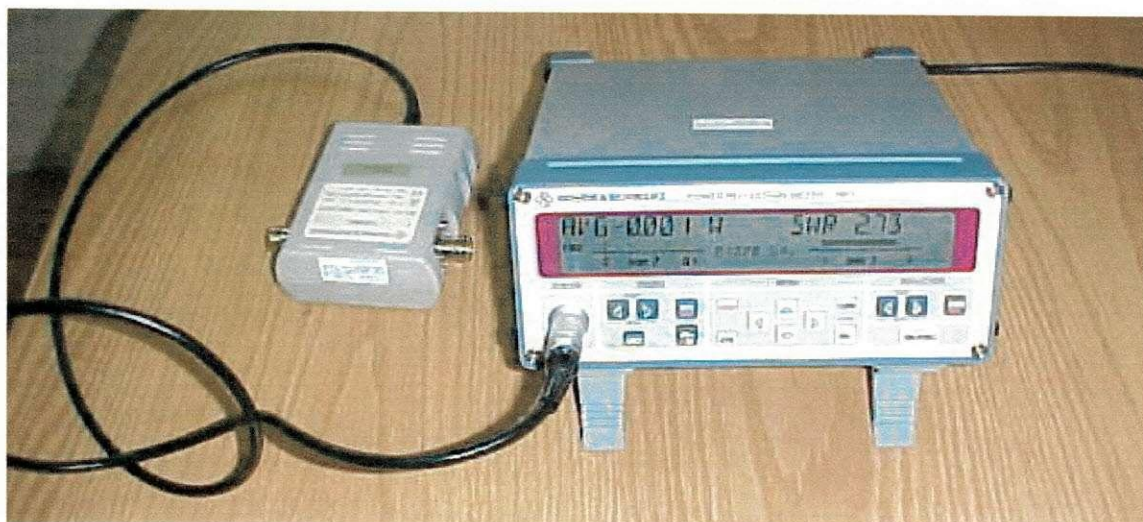
Figura 6 – Medidor de potência refletida NRT.
