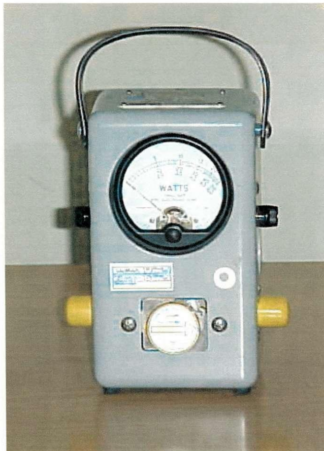
Figura 4 – Wattímetro Analógico Bird Thru-line 4311.
