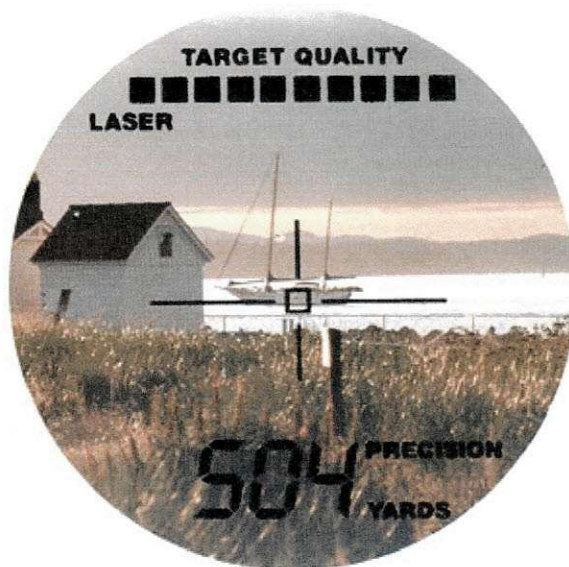
Figura 8 – Exemplo de medição usando o telêmetro.
