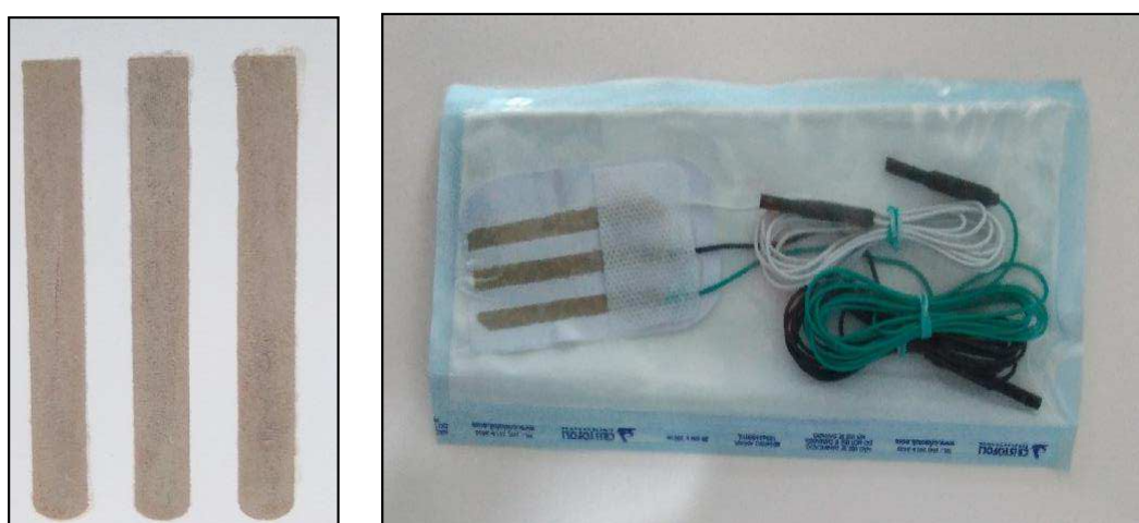
Figura 13 - Eletrodo de superfície desenvolvido (Fonte: Própria).
