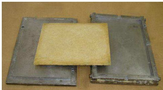
Figura 3.3 – Compósito reforçado com fibras de macambira.
