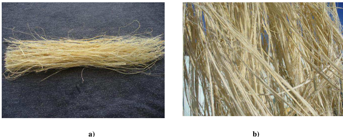
Figura 3.2 – a) Macambira desfibrada manualmente e b) Macambira penteada manualmente tamanho 3 cm .
