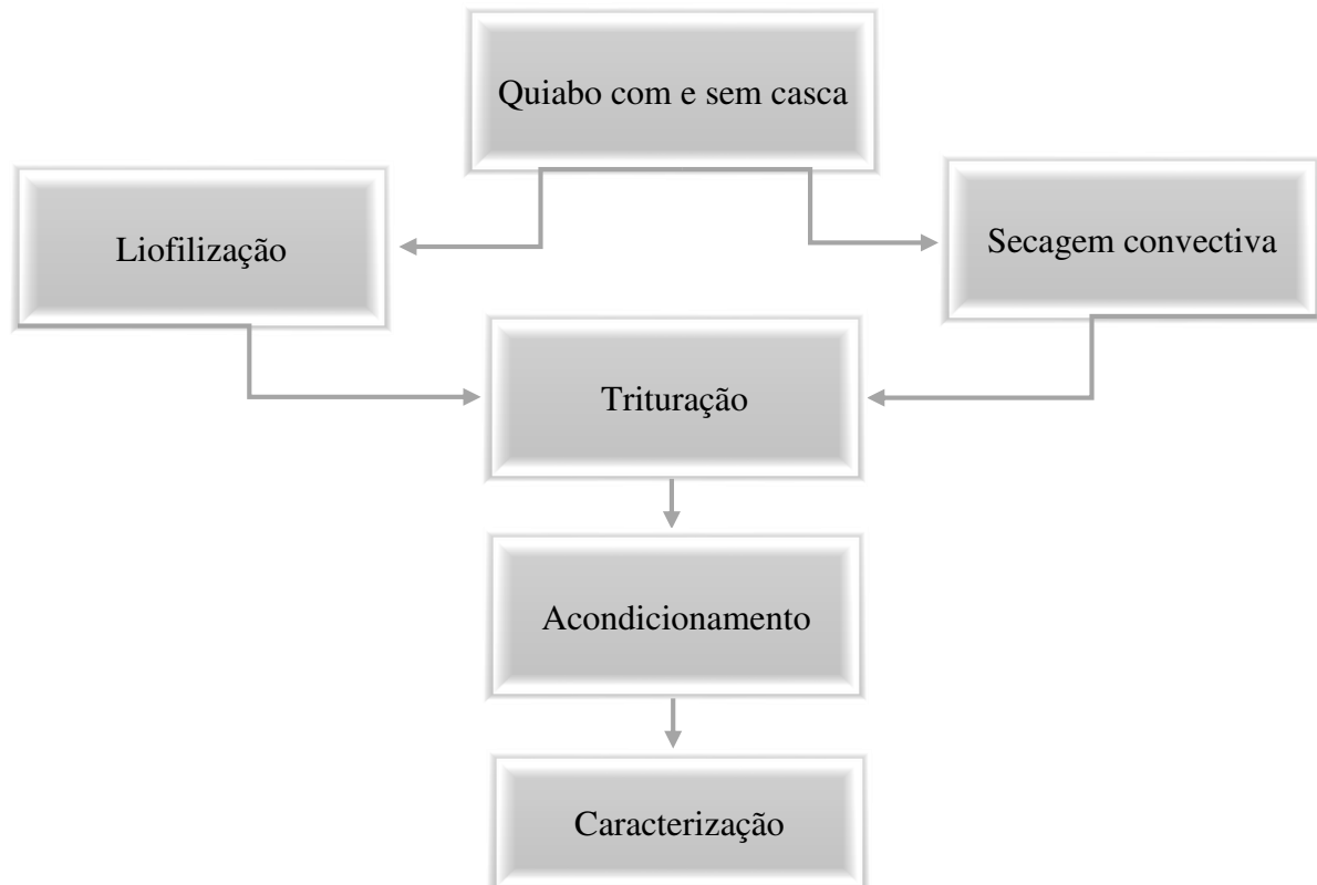
Figura 3.4 - Fluxograma do processamento para obtenção dos pós do quiabo com e sem casca
