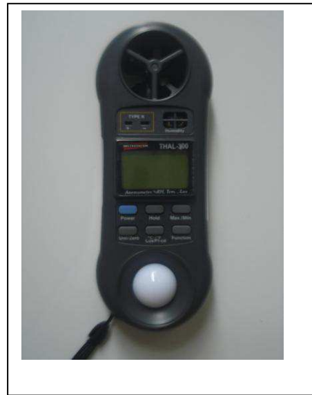
Figura 22 - Termo-Higro-Anemômetro- Luxímetro digital portátil marca Instrutherm, modelo THAL 300
