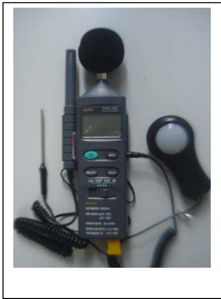
Figura 21 - Termo-Higro-Decibelímetro- Luxímetro digital portátil marca Instrutherm, modelo THDL 400
