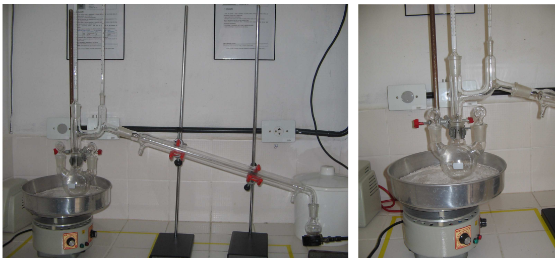
Figura 3.5: Sistema S1 montado para produção do biodiesel.
