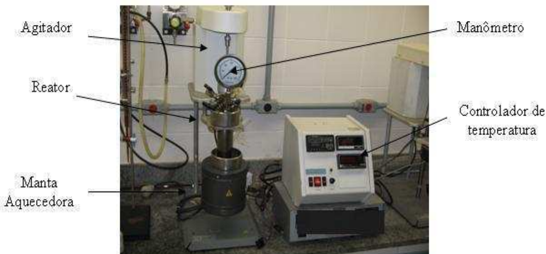
Figura 3.10: Equipamento para a produção de biodiesel composto de: Reator PARR 4842, manômetro, agitador e sistema de aquecimento.
