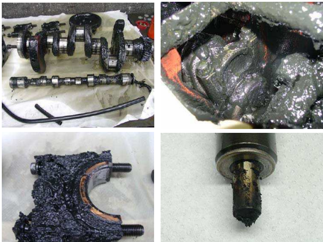
Figura 2.4- Acúmulo de borras no interior do motor e depósito de carvão no bico injetor, observadas com o uso de óleo bruto de girassol.
